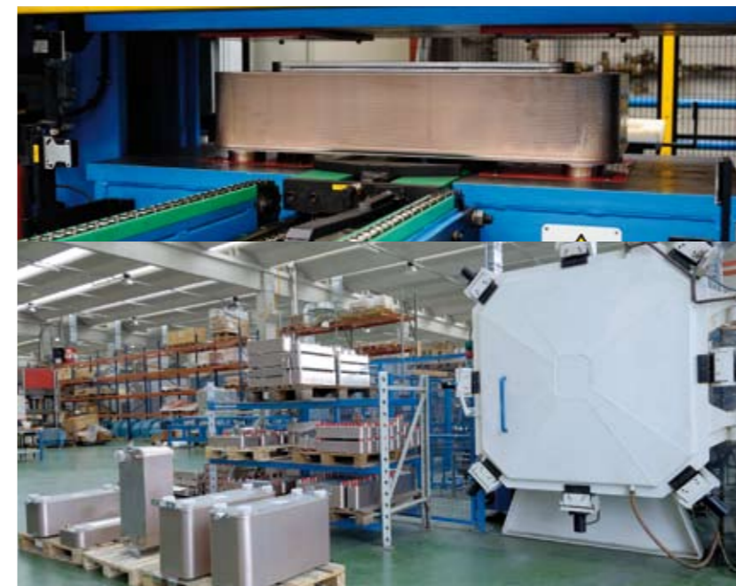
In the new fully automatic test machine the brazed plates heat exchangers are tested for a working pressure up to 30 bar (45 bar for the H version). Nella nuova postazione di collaudo totalmente automatizzata le piastre vengono testate per una pressione di lavoro fino a 30 bar e, nella versione H, fino a 45 bar.
