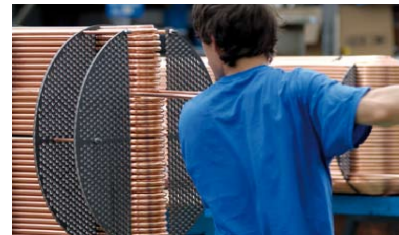
Mounting operation of shell and tube evaporators with increasingly bigger diameters and capacities. Assemblaggio di fasci tubieri con diametri e potenze sempre maggiori.
